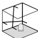
Transportsikringen skal ikke løsnes, skyv skyvbryteren (3) mot høyre. Laseren slås på med PÅ/AV-knappen. Nå kan instrumentet legges på skjeve flater. I denne modus kan det ikke nivelleres horisontalt eller vertikalt, da laserlinjene ikke innretter seg automatisk mer. LED-en (1) og laserlinjene blinker rødt.
