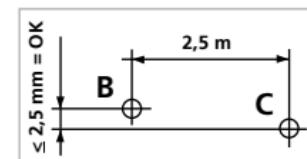
Vérifiez si la ligne horizontale du point C se trouve à  $\pm 2,5$  mm à la même hauteur que le point B. Répétez l'opération en faisant pivoter vers la gauche.
