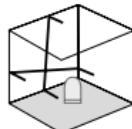
No abrir el seguro de transporte, cambiar el interruptor deslizante (3) hacia la derecha. Ahora pueden realizarse planos inclinados. En este modo no se puede nivelar horizontal o verticalmente, ya que las líneas láser no se orientan automáticamente. El LED (1) y las líneas láser parpadean con luz roja.
