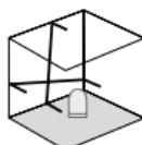
Non allentare la sicurezza di trasporto, spostare l'interruttore a scorrimento (3) verso destra. È ora possibile tracciare piani inclinati. In questa modalità non si può livellare orizzontalmente o verticalmente, in quanto le linee laser non si orientano più automaticamente.
