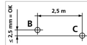
Controleer nu of de waterpaslijn van punt C op gelijke hoogte ligt met punt B - met een tolerantie van max.  $\pm 2,5$  mm. Dezelfde controle kunt u tevens naar links uitvoeren.
