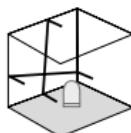
Älä löysää kuljetusvarmistinta, työnnä liukukytkin (3) oikealle. Kytke laser päälle ON/OFF-näppäimellä. Nyt voit mitata kaltevia pintoja. Tässä tilassa ei voida linjata vaaka- tai pystysuorassa, sillä laserlinjat eivät enää tasaudu automaattisesti. Punainen ledi (1) ja punaiset laserviivat vilkkuvat.
