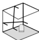
Ne pas dégager le blocage de transport, faire glisser l'interrupteur à coulisse (3) vers la droite. Il est maintenant possible de travailler sur des plans inclinés. Il n'est pas possible d'effectuer un niveling horizontal ou vertical dans ce mode étant donné que les lignes laser ne s'orientent plus automatiquement. La LED (1) et les lignes laser clignotent en rouge.
