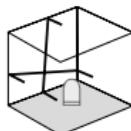
Lossa inte transportsäkringen, och skjut strömbrytaren (3) åt höger. Laserapparaten slås på med PÅ/AV-knappen. Nu kan lutande plan skapas. I detta läge kan inte horisontell eller vertikal nivellering göras, eftersom laserlinjerna inte längre justeras in automatiskt. LED (1) och laserlinjerna blinkar rött.
