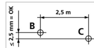
! Verifique regularmente a calibragem antes de usar, após transportes e depois de armazenar durante bastante tempo.
