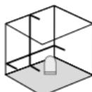
Aava kuljetusvarmistus, siirrä liukukytkin (3) vasemmalle. Laserristi näkyy.
