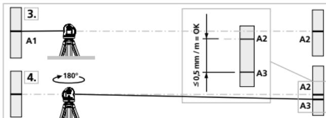
! Jos A2 ja A3 ovat toisistaan etäisyydellä kuin  $0,5 \text{ mm} / \text{m}$ , on säätö tarpeen. Ota yhteys paikalliseen laitetoimittajaan tai UMAREX-LASERLINER huolto-osastoon.
