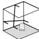
Transportsikringen skal ikke løsnes, skyv skyvebryteren (3) mot høyre. Laseren slås på med PÅ/AV-knappen. Nå kan instrumentet legges på skjeve flater. I denne modus kan det ikke nivelleres horisontalt eller vertikalt, da laserlinjene ikke innretter seg automatisk mer. LED-en (1) og laserlinjene blinker grønt.
