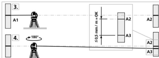
! Wanneer het verschil tussen punt A2 en A3 groter is dan de aangegeven tolerantie, nl.  $0,5 \text{ mm} / \text{m}$ , is een kalibratie nodig.
