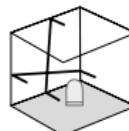
No abrir el seguro de transporte, cambiar el interruptor deslizante (3) hacia la derecha. Ahora pueden realizarse planos inclinados. En este modo no se puede nivelar horizontal o verticalmente, ya que las líneas láser no se orientan automáticamente. El LED (1) y las líneas láser parpadean con luz verde.
