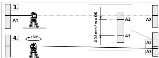
! Quand A2 et A3 sont distants de plus de 0,5 mm / m l'un de l'autre, un réglage de l'appareil est nécessaire. Prenez contact avec votre revendeur ou appelez le service après-vente de UMAREX-LASERLINER.
