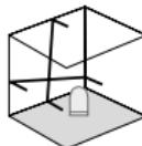
Die Transportsicherung nicht lösen, Schiebeschalter (3) nach rechts schieben. Die Laser mit der AN/AUS-Taste anschalten. Jetzt können schräge Ebenen angelegt werden. In diesem Modus kann nicht horizontal bzw. vertikal nivelliert werden, da sich die Laserlinien nicht mehr automatisch ausrichten. Die LED (1) und die Laserlinien blinken grün.
