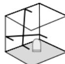
Não solte o bloqueador de transporte, deslide o interruptor de corrediça (3) para a direita. Ligue os lasers com o botão para ligar/desligar. A seguir podem ser traçados níveis inclinados. Neste modo não é possível nivelar horizontal e verticalmente, uma vez que as linhas de laser não se alinham automaticamente. Os LED (1) e a linha de laser piscam a verde.
