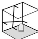
Non allentare la sicurezza di trasporto, spostare l'interruttore a scorrimento (3) verso destra. È ora possibile tracciare piani inclinati. In questa modalità non si può livellare orizzontalmente o verticalmente, in quanto le linee laser non si orientano più automaticamente. Il LED (1) e le linee laser lampeggiano in verde.
