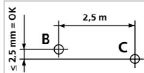
! Compruebe regularmente la calibración antes del uso, después de los transportes y después de almacenajes prolongados.
