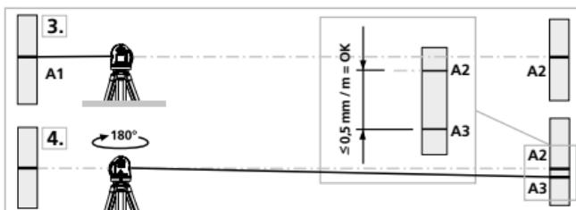
! Si A2 y A3 se encuentran a más de 0,5 mm / m entre sí, será necesaria un ajuste. Póngase en contacto con su distribuidor especializado o diríjase al Servicio Técnico de UMAREX-LASERLINER.
