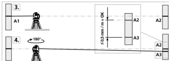
! Om A2 och A3 ligger mer än  $0,5 \text{ mm} / \text{m}$  från varandra behöver enheten justeras. Kontakta er återförsäljare eller vänd er till serviceavdelningen på UMAREX-LASERLINER.
