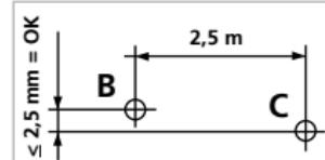
C noktasındaki yatay çizginin B noktasıyla  $\pm 2,5$  mm'lik bir aralıkta aynı hızda bulunup bulunmadığın kontrol ediniz. Aynı işlemi bu sefer sola kaydırarak tekrar ediniz.
