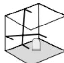
Løsn ikke transportsikringen, skub skydekontakten (3) til højre. Nu kan der anlægges skæve niveauer. I denne modus kan der hverken nivelleres horisontalt eller vertikalt, da laserlinjerne ikke længere indjusterer sig automatisk. LED-lampen (1) og laserlinjerne blinker grøn.
