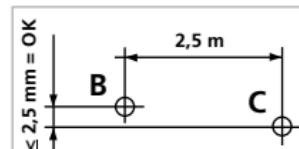
Controleer nu of de waterpaslijn van punt C op gelijke hoogte ligt met punt B - met een tolerantie van max.  $\pm 2,5 \text{ mm}$ . Dezelfde controle kunt u tevens naar links uitvoeren.
